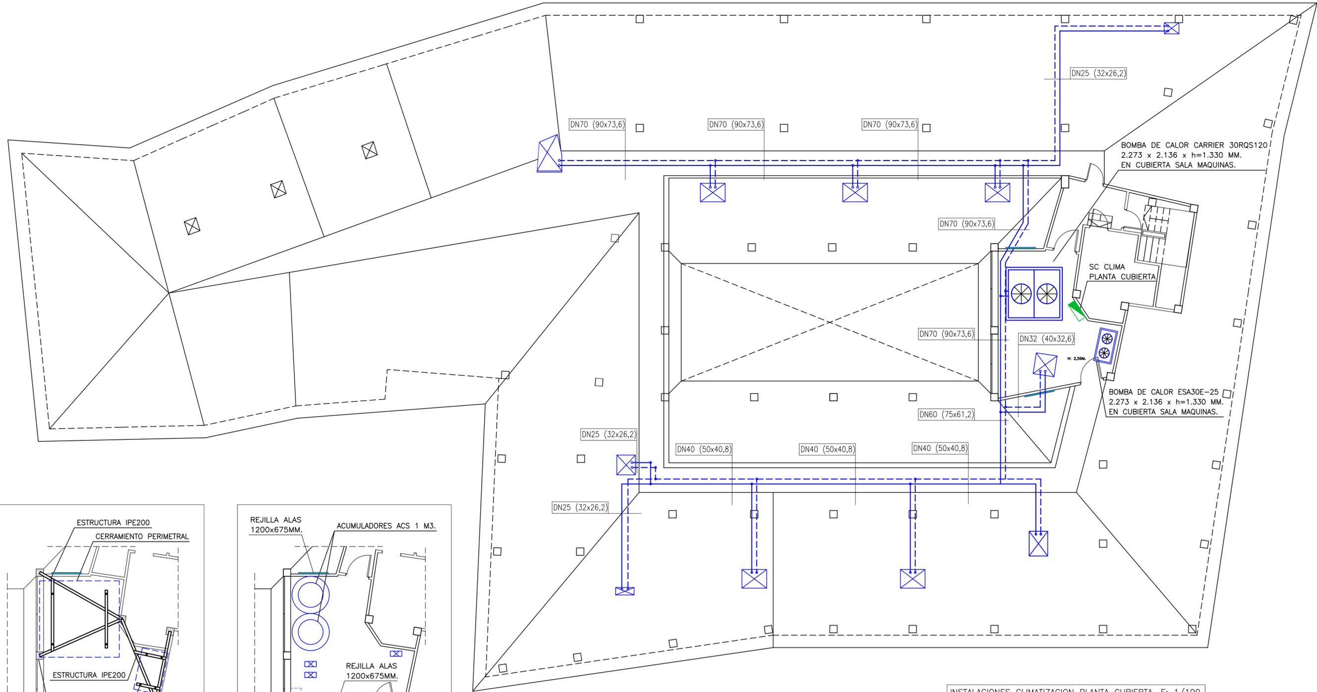
BOMBA DE CALOR CARRIER 30RQS120 / 2.273 x 2.136 x h=1.330 MM. EN CUBIERTA SALA MAQUINAS.
